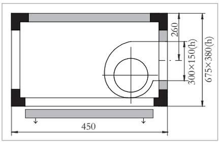
вентилятор с непосредственным приводом
