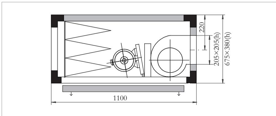
вентилятор с непосредственным приводом и карманным фильтром
